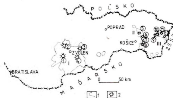
Obr. 1. Situačná schéma rozšírenia neovolkanitov na Slovensku. 1 — rozsah vulkanických hornín (I — stredoslovenské neovolkanity — Slovenské stredohorie, II — Slanské vrchy, III — Vihorlatské vrchy), 2 — centrálné zóny andezitových stratovulkánov s ložiskami a prejavmi mineralizácie a hydrotermálnych premien: ① — Banská Štiavnica, ② — Kremnica, ③ — Poľana, ④ — Javorie, ⑤ — Zlatá Baňa, ⑥ — Makovica, ⑦ — Strechový vrch, ⑧ — Bogota, ⑨ — Kyjov, ⑩ — Sokolský potok, ⑪ — Morské oko, ⑫ — Diel.
